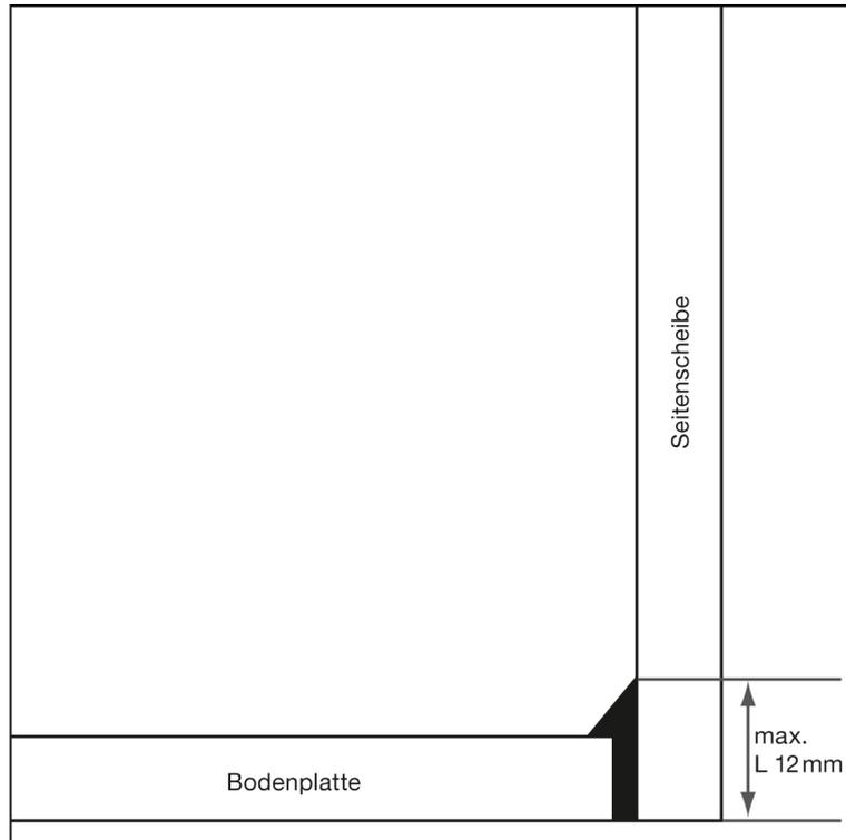
Zur Dimensionierung der Klebefugen empfehlen wir je nach Glasdicke eine Mindestbreite der Klebfuge von 2 mm. Bei einer Glasdicke von 8 mm empfehlen wir Klebfugen mit 2-3 mm Breite und bei Glasdicken von 12 mm bis 15 mm eine Breite der Klebfugen von 3-4 mm.
